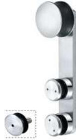
2 Soportes guía puerta-tubo con ruedas recubiertas de nylon antifricción (facilitan el deslizamiento evitando el desgaste). Incorporan protectores de goma y casquillos de nylon entre las partes de metal y la puerta.
