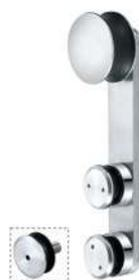
2 Soportes guía puerta-tubo con ruedas recubiertas de nylon antifricción (facilitan el deslizamiento evitando el desgaste). Incorporan protectores de goma y casquillos de nylon entre las partes de metal y la puerta.
